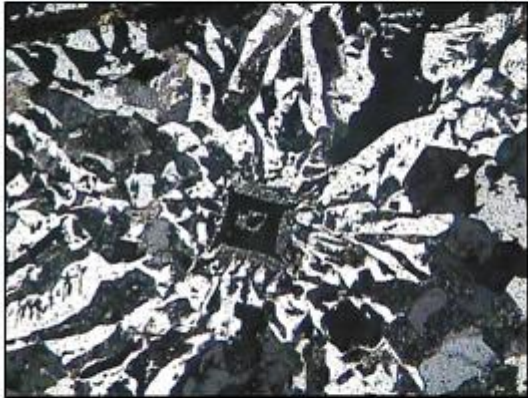
Sezione sottile V82 di un campione di Granofiro preso nelle vicinanze della miniera. ( Particolare di K-Feldspato, Nicols incrociati e ingrandimento 32x)
