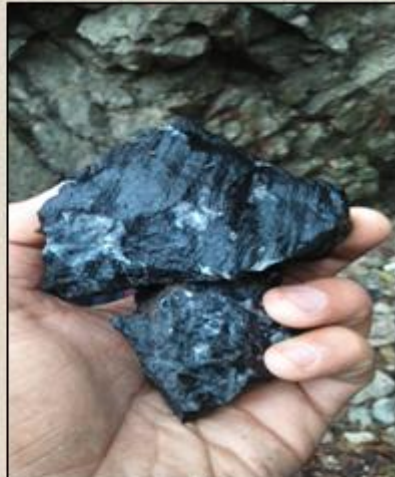
Campione di litantrace . (è il più noto e diffuso tipo di carbon fossile, di colore nero lucente, povero di bitume e con circa l'80% di carbonio).
